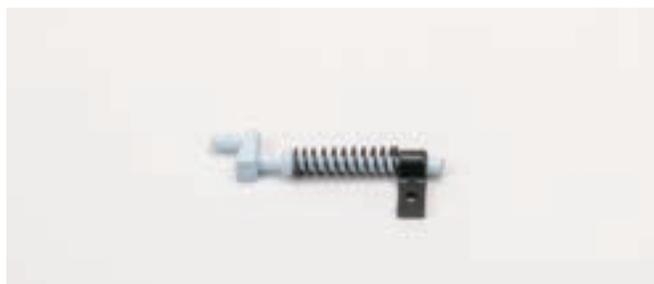
Наденьте пружину на ось замка двери. Далее вставьте ось замка в отверстие кронштейна замка передней двери. Проверьте легкость хода оси замка в отверстии кронштейна.
