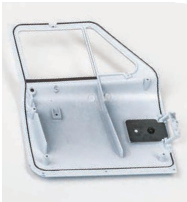
Накройте установленную ранее петлю фиксатором. Совместите центровочные элементы двери и фиксатора и закрепите его винтом 2,3×3 с пресс-шайбой (KM) с внутренней стороны двери. При закручивании винта следите за тем, чтобы крепежное отверстие фиксатора (под винтом) было совмещено с крепежным штифтом. В противном случае ось петли не будет прижата пружинным фиксатором к внутренней поверхности передней двери. По окончании фиксации проверьте подвижность петли.
